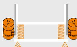
Pour les convoyeurs, séparateurs, tamis, calibreurs, extracteurs, orientateurs, classificateurs, alimentateurs et lits fluidisés: méthode unidirectionnelle.
